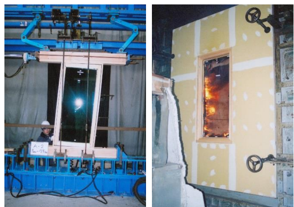
写真2.(4).カ 超断熱木製サッシ性能試験 左 面内せん断試験状況 右 遮炎性能試験状況
