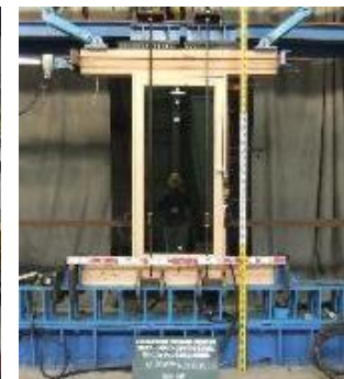
Ảnh 3.8 Kiểm tra hiệu suất biến dạng trong mặt phẳng
