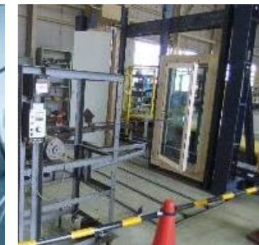
Ảnh 3.7 Kiểm tra hiệu suất đóng/mở lặp đi lặp lại
