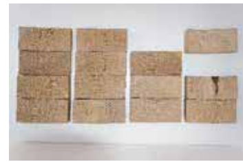
写真-37 アメリカ試験パネル原板 カラマツ 厚 65mm 用 左からパネル 1、2、3、4
