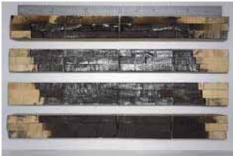
写真-176 試験パネル延焼面抜取り カラマツ 厚 65mm 1 枚目パネル：上段 3 列 2 枚目パネル：下段 3 列 3 枚目パネル：上段 3 列 4 枚目パネル：下段 3 列
