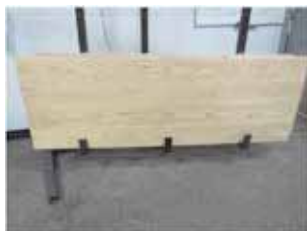
写真-136 試験パネル養生期間 5 日 アカマツ 65mm 2022 年 2 月 7 日 Intertek
