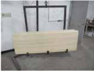
写真-132 試験パネル養生期間 5 日 ヒノキ 65mm 2022 年 2 月 7 日 Intertek
