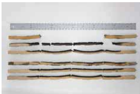
写真-162 試験パネル断面 アカマツ 厚 15mm 1 枚目パネル：上段 3 列 2 枚目パネル：下段 3 列
