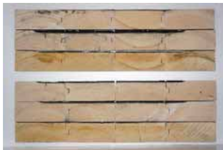
写真-168 試験パネル断面 ヒノキ 厚 65mm 1 枚目パネル：上段 3 列 2 枚目パネル：下段 3 列
