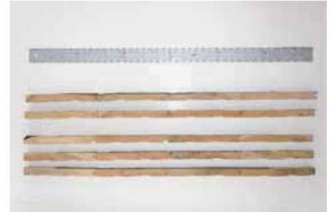
写真-157 試験パネル断面 スギ 厚 15mm 3 枚目パネル：上段 3 列 4 枚目パネル：下段 3 列
