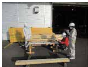
写真-41 製品試験体用原板 品質検査 ヤング率 E f 計測 アメリカ試験用厚 65mm ヒノキ
