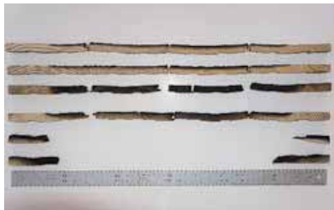
写真-114 試験後試験体パネル断面 アカマツ 1 枚目パネル：下段 3 列 2 枚目パネル：上段 3 列
