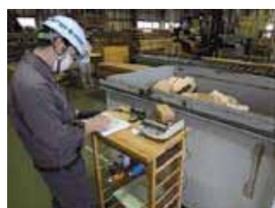
写真-26 切断した材から製品試験体の含水率試験サンプル採取状況
