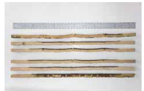
写真-163 試験パネル断面 アカマツ 厚 15mm 3 枚目パネル：上段 3 列 4 枚目パネル：下段 3 列
