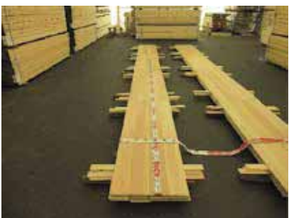
写真-61 製品試験パネル 厚 15mm スギ 日本確認試験用 製品位置確認状況
