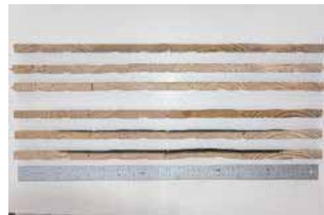
写真-109 試験後試験体パネル断面 カラマツ 3枚目パネル：下段3列 4枚目パネル：上段3列
