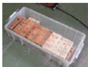
写真-27 製品試験体から採取した含水率・比重計測用サンプル
