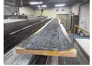
写真-143 試験後/試験面 スギ 65mm 2022 年 2 月 7 日 Intertek
