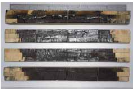
写真-170 試験パネル延焼面抜取り アカマツ 厚 65mm 1 枚目パネル：上段 3 列 2 枚目パネル：下段 3 列 3 枚目パネル：上段 3 列 4 枚目パネル：下段 3 列
