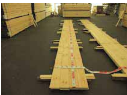
写真-58 製品試験パネル 厚 15mm アカマツ 日本確認試験用 製品位置確認状況
