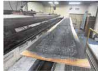
写真-123 試験後/試験面 カラマツ 15mm 2022 年 2 月 7 日 Intertek
