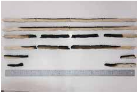
写真-102 試験後試験体パネル断面 ヒノキ 1枚目パネル：下段3列 2枚目パネル：上段3列
