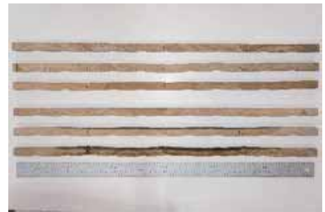
写真-97 試験後試験体パネル断面 スギ 3枚目パネル：下段3列 4枚目パネル：上段3列
