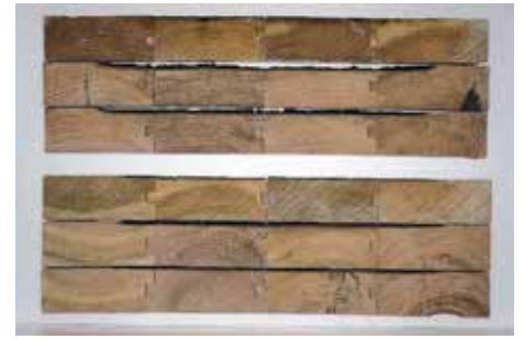
写真-175 試験パネル断面 スギ 厚 65mm 3 枚目パネル：上段 3 列 4 枚目パネル：下段 3 列
