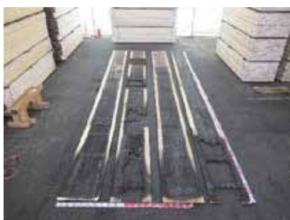
写真-151 試験後試験体パネル 厚み 15mm 燃焼口側 左からヒノキ・スギ・カラマツ・アカマツ
