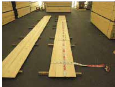
写真-53 製品試験パネル 厚 15mm ヒノキ アメリカ試験用 製品位置確認状況
