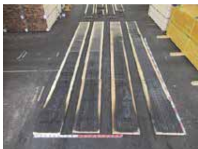
写真-153 試験後試験体パネル 厚み 65mm 燃焼口側 左からヒノキ・スギ・カラマツ・アカマツ
