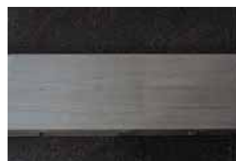
写真-71 製品試験パネル 厚 15mm ヒノキ 試験面 日本確認試験用
