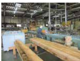
写真-25 表面品質確認した乾燥後の木材4m材を製品加工長さに切断
