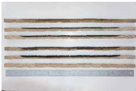
写真-108 試験後試験体パネル断面 カラマツ 1枚目パネル：下段3列 2枚目パネル：上段3列
