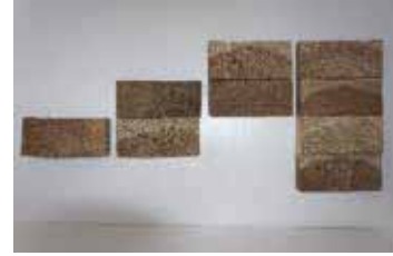
写真-34 アメリカ試験パネル原板 スギ 厚 65mm 用 左からパネル 1、2、3、4
