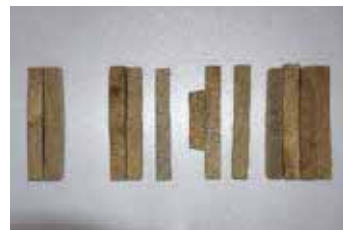
写真-39 アメリカ試験パネル原板 アカマツ 厚 15mm 用 左からパネル 1、2、3、4
