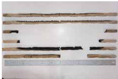
写真-96 試験後試験体パネル断面 スギ 1枚目パネル：下段3列 2枚目パネル：上段3列
