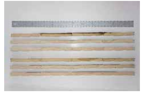
写真-166 試験パネル断面 ヒノキ 厚 15mm 3 枚目パネル：上段 3 列 4 枚目パネル：下段 3 列
