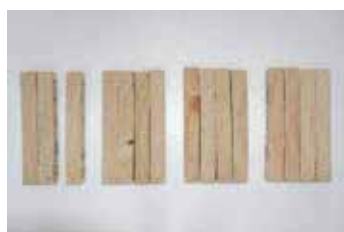
写真-30 アメリカ試験パネル原板 ヒノキ 厚15mm用 左からパネル1、2、3、4
