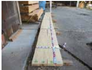
写真-44 製品試験体用原板 アメリカ試験用厚 65mm アカマツ
