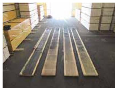
写真-154 試験後試験体パネル 厚み 65mm 排気側 左からアカマツ、カラマツスギ、ヒノキ
