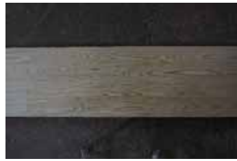
写真-77 製品試験パネル 厚 15mm カラマツ 試験面 アメリカ試験用
