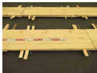
写真-60 製品試験パネル 厚 15mm アカマツ 下：アメリカ試験用 上：日本確認試験用 製品位置確認状況
