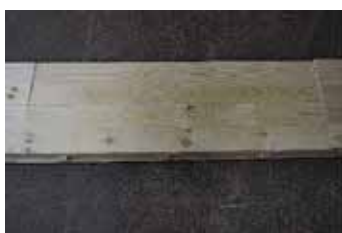
写真-69 製品試験パネル 厚 15mm アカマツ 試験面 日本確認試験用
