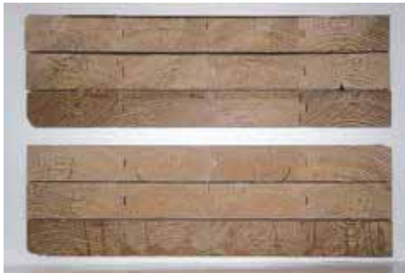
写真-177 試験パネル断面 カラマツ 厚 65mm 1 枚目パネル：上段 3 列 2 枚目パネル：下段 3 列
