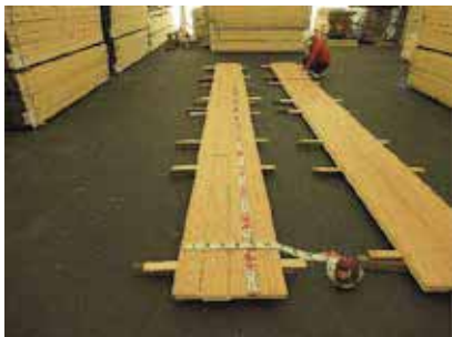
写真-55 製品試験パネル 厚 15mm カラマツ 日本確認試験用 製品位置確認状況
