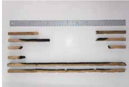
写真-156 試験パネル断面 スギ 厚 15mm 1 枚目パネル：上段 3 列 2 枚目パネル：下段 3 列
