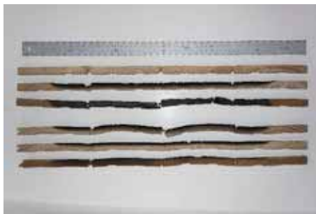
写真-159 試験パネル断面 カラマツ 厚 15mm 1 枚目パネル：上段 3 列 2 枚目パネル：下段 3 列
