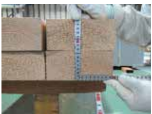
写真-21 製品試験体用原板 品質検査 アメリカ試験用厚 65mm スギ
