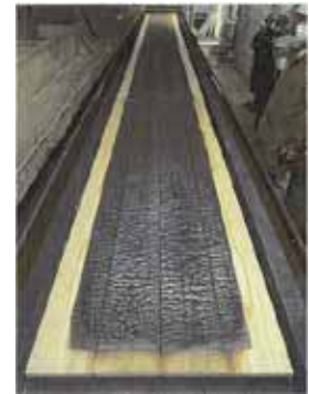
写真-107- 試験後/試験面 カラマツ 15mm 2021年12月21日 (社)電線総合技術センター
