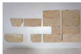
写真-31 アメリカ試験パネル原板 ヒノキ 厚65mm用 左からパネル1、2、3、4
