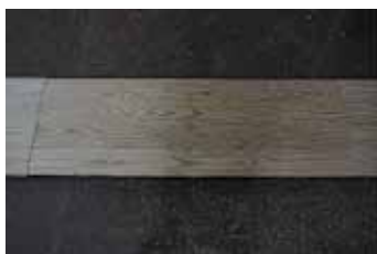
写真-65 製品試験パネル 厚 15mm カラマツ 試験面 日本確認試験用
