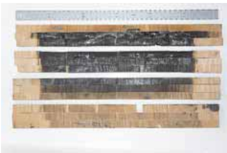
写真-158 試験パネル延焼面抜取り カラマツ 厚 15mm 1 枚目パネル：上段 3 列 2 枚目パネル：下段 3 列 3 枚目パネル：上段 3 列 4 枚目パネル：下段 3 列
