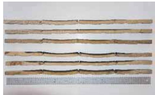
写真-115 試験後試験体パネル断面 アカマツ 3 枚目パネル：下段 3 列 4 枚目パネル：上段 3 列
