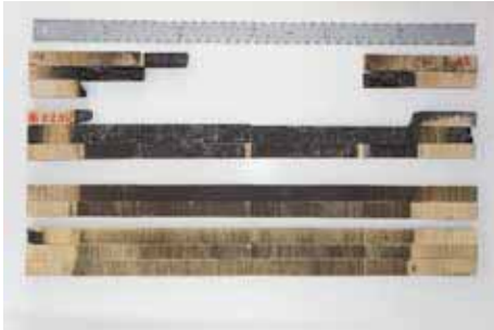
写真-155 試験パネル延焼面抜取り スギ 厚 15mm 1 枚目パネル：上段 3 列 2 枚目パネル：下段 3 列 3 枚目パネル：上段 3 列 4 枚目パネル：下段 3 列
