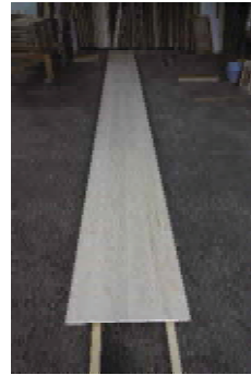
写真-78 製品試験パネル 厚 15mm ヒノキ 試験面 アメリカ試験用
