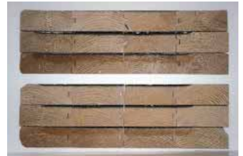
写真-178 試験パネル断面 カラマツ 厚 65mm 3 枚目パネル：上段 3 列 4 枚目パネル：下段 3 列
