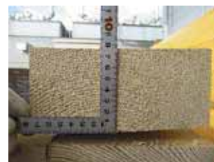
写真-24 製品試験体用原板 品質検査 アメリカ試験用厚 65mm ヒノキ
