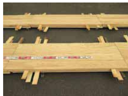
写真-63 製品試験パネル 厚 15mm スギ 下：アメリカ試験用 上：日本確認試験用 製品位置確認状況
