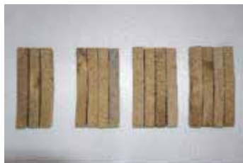
写真-38 日本試験パネル原板 アカマツ 厚 15mm 用 左からパネル 1、2、3、4
