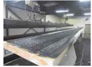
写真-135 試験後/試験面 ヒノキ 65mm 2022 年 2 月 7 日 Intertek
