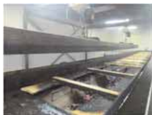
写真-127 試験後 アカマツ 15mm 2022 年 2 月 7 日 Intertek
