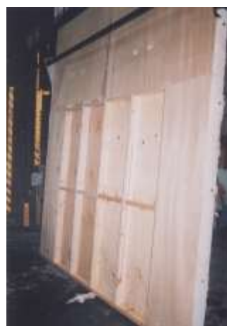
壁内部 / 燃焼による損傷無し
