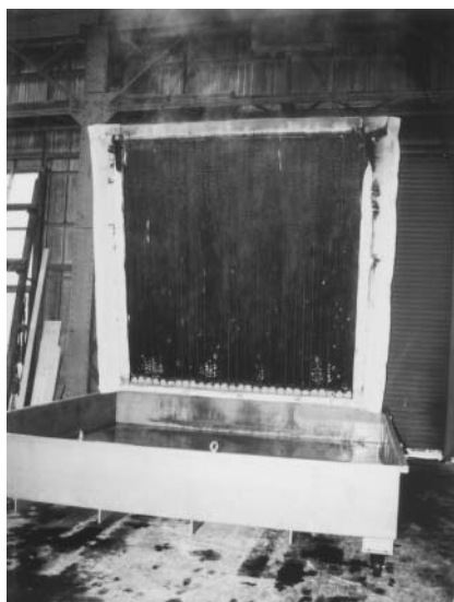
写真5 試験体加熱面（評価試験終了時）
