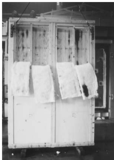
写真4 試験体裏面（壁内部状況）
